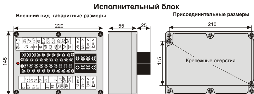
Рис.2-1. Внешний вид и габаритные и присоединительные размеры исполнительного блока.
