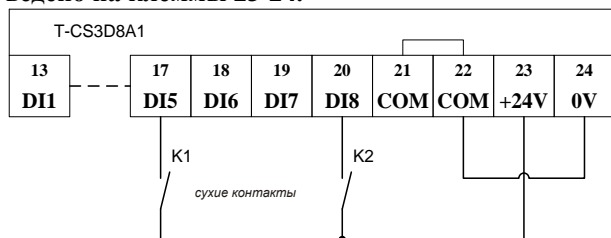
Рис.1. Вариант подключения сухих контактов с общим проводом положительной полярности.
