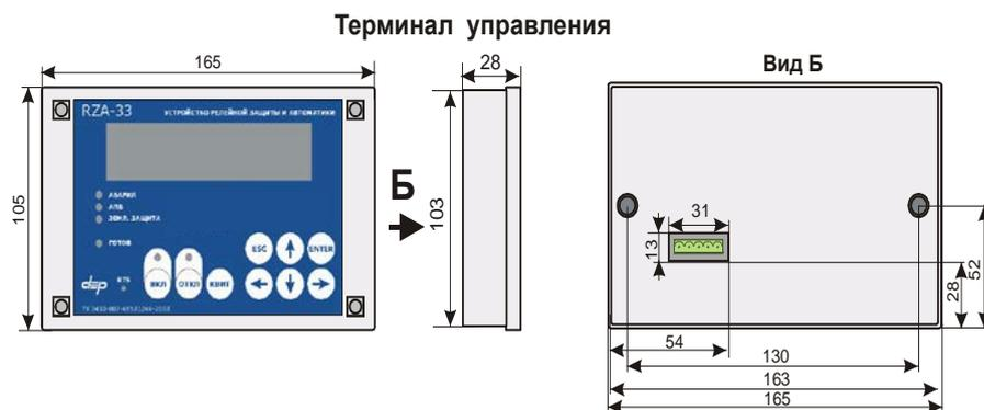
Рис.2-3 -Внешний вид, габаритные и присоединительные размеры терминала управления
