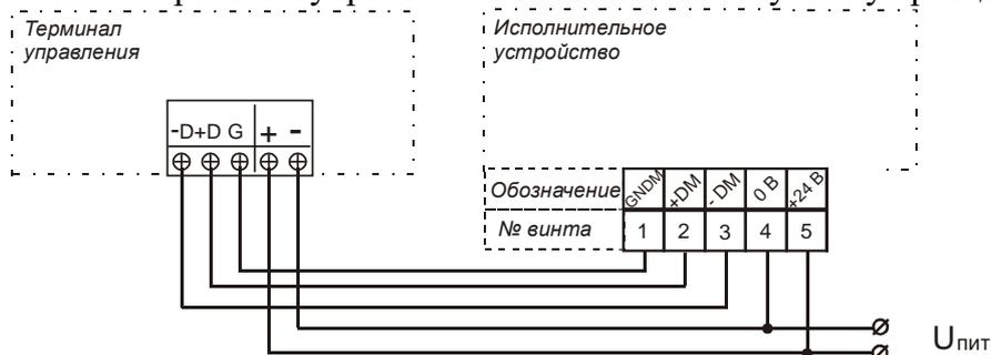
Рис.3-7.Схема подключения терминала управления.
